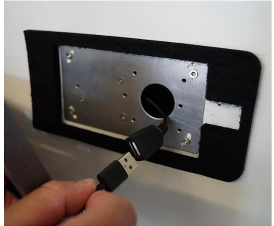
**Schritt 4** Befestigen Sie das free mit den beigelegten Schrauben (2,5mm Innensechskant) an der Montageplatte.
