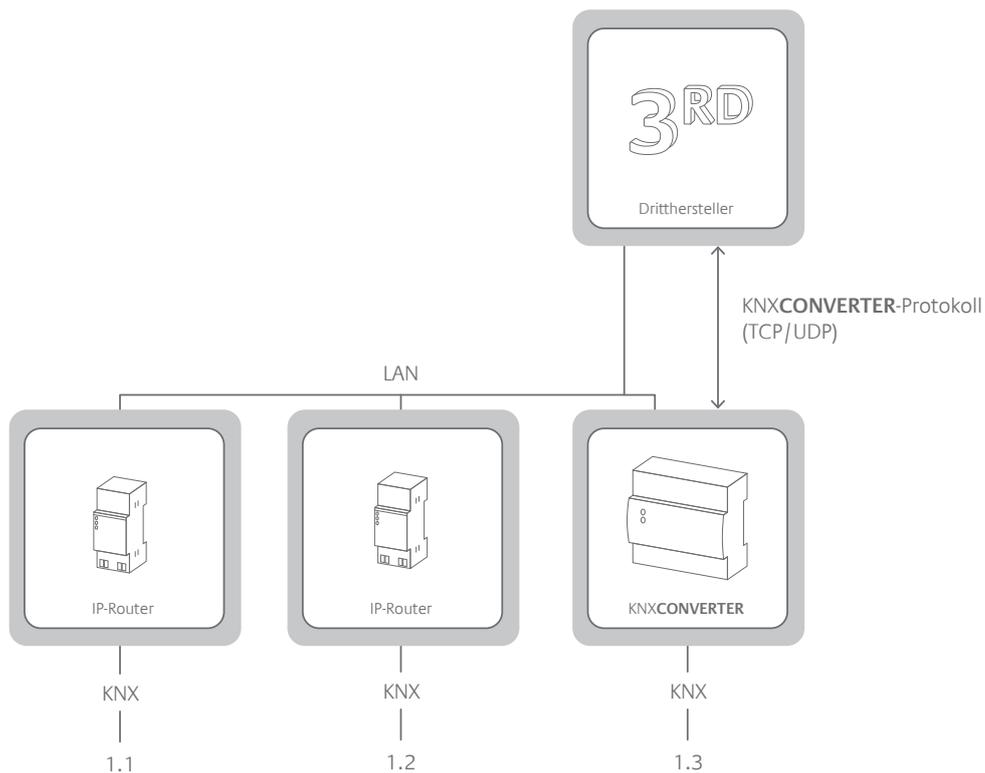
In größeren Installationen ersetzt der **KNXCONVERTER** durch den integrierten KNXnet/IP-Server einen IP-Router. Mit Hilfe des **KNXCONVERTER-Protokolls** sind Drittanwendungen bidirektional mit der kompletten Anlage verbunden. So werden bei geringem Mehraufwand die Vorteile beider Welten ideal miteinander verknüpft.
