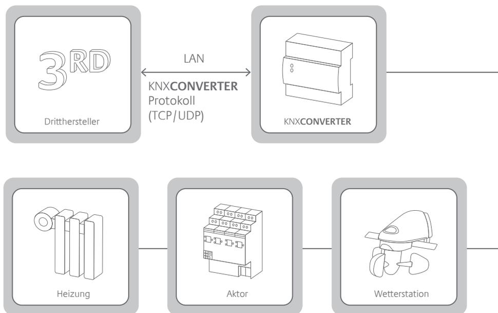
KNX**CONVERTER** wird als weiterer KNX-Teilnehmer an den Twisted Pair Bus angeschlossen. Die Drittanwendung kommuniziert nach Implementierung des KNX**CONVERTER**-Protokolls über das Netzwerk (TCP oder UDP) bidirektional mit dem KNX**CONVERTER**. Dadurch erhält die fremde Anwendung vollen Zugriff auf das KNX-System und umgekehrt.
